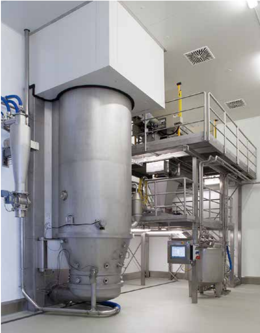
Multifunktionale Wirbelschichtanlage zur schonenden Hefetrocknung
