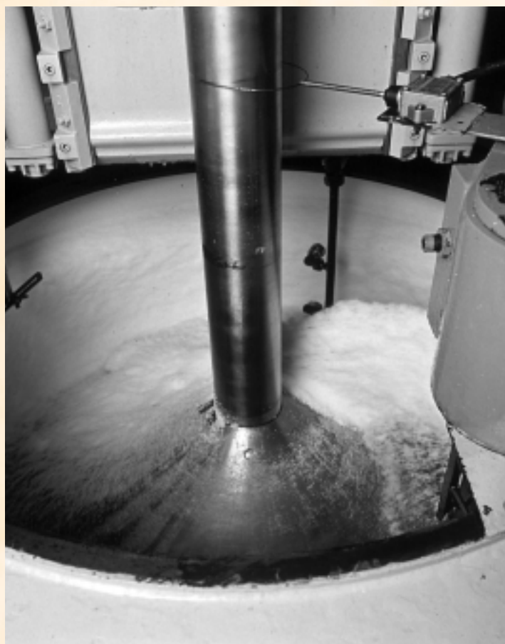
Eine Zentrifuge in der die Zuckerkristalle mittels Fliehkraft aus der Füllmenge gewonnen werden.
