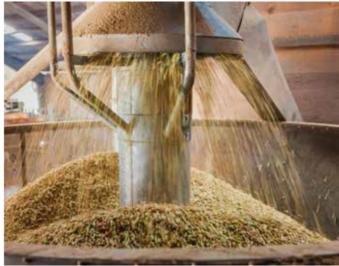
Abbildung 3 Moderne Grünkerndarre mit Trocknungsturm. Foto: © IREKS GmbH
