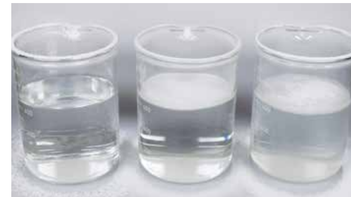
Abb. 08: Wassertest bei 40 °C mit Puderzucker (links), Dekorpunder A (mittig) und Dekorpunder B (rechts), Quelle: UNIFERM GmbH & Co. KG
