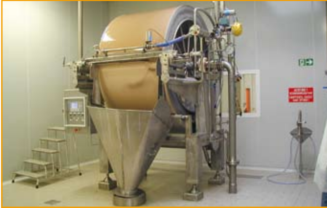
Abbildung 6: Vakuum-Drehfilter zur Filtration der Hefemilch
