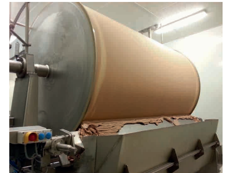
Vakuum-Drehfilter, Vorder- und Rückseite (v.l.n.r.)
